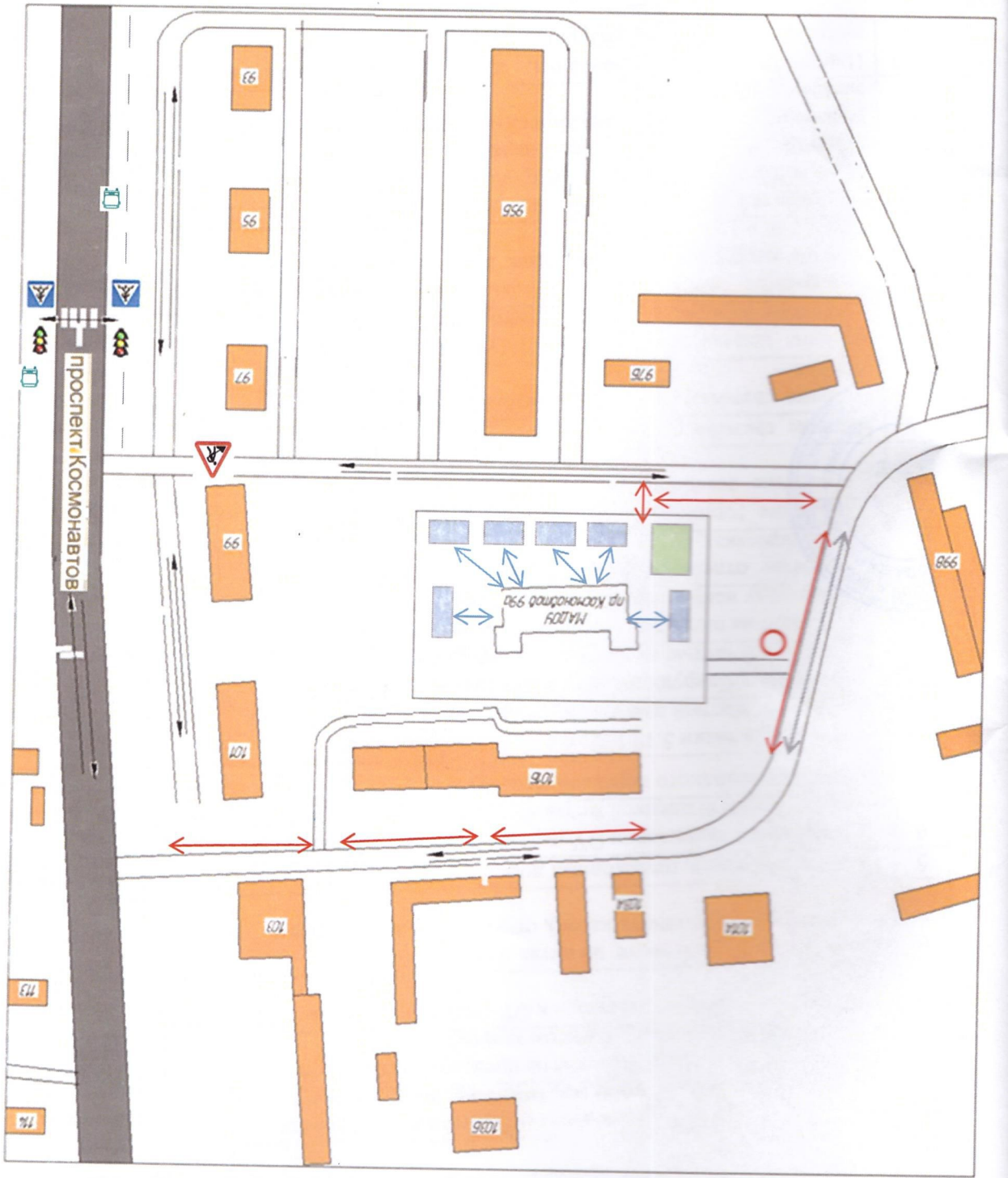
III. План – схема пути движения транспортных средств и детей при проведении дорожных ремонтно – строительных работ вблизи образовательного учреждения.
